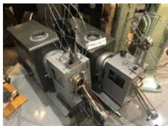
移動用 35mm 新響製映写機 （型式 GX-1600） ※岐阜土地興行より寄贈
